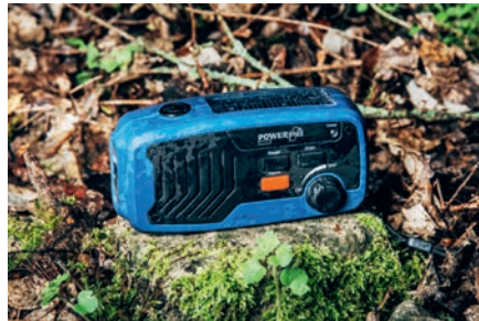
Oben: Die Hängematte kommt ohne Knoten aus und lässt sich in drei Minuten auf- und abbauen. Der Abstand zum Boden schützt vor Tieren und Wind, das Segel vor Nässe und Wind. Links: Das Kurbelradio mit USB-Anschluss und Solarfunktion empfängt Notsender, lädt das Telefon auf und spendet Licht.
