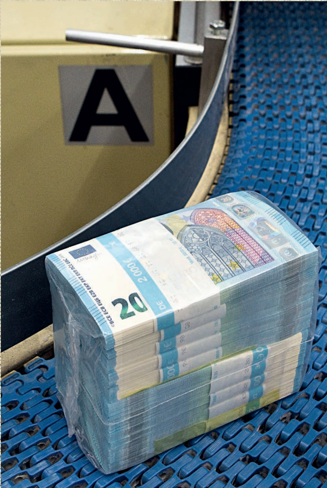
Ein Päckchen mit frischen 20-Euro-Noten verlässt die Druckerei – zuvor wurde das kostbare Papier sechs Wochen lang präpariert und gepresst, mehrfach bedruckt, getrocknet und streng geprüft.
